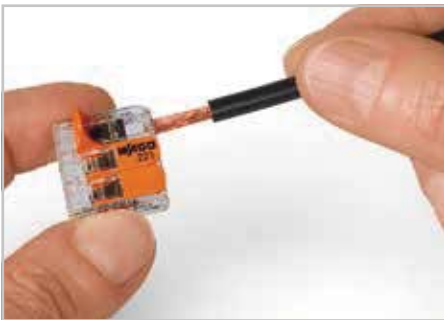
전선 연결 방법: 레버를 사용하여 클램핑 유닛을 열고 전선을 삽입합니다. 그 다음 레버를 아래로 눌러 클램프를 닫습니다.
